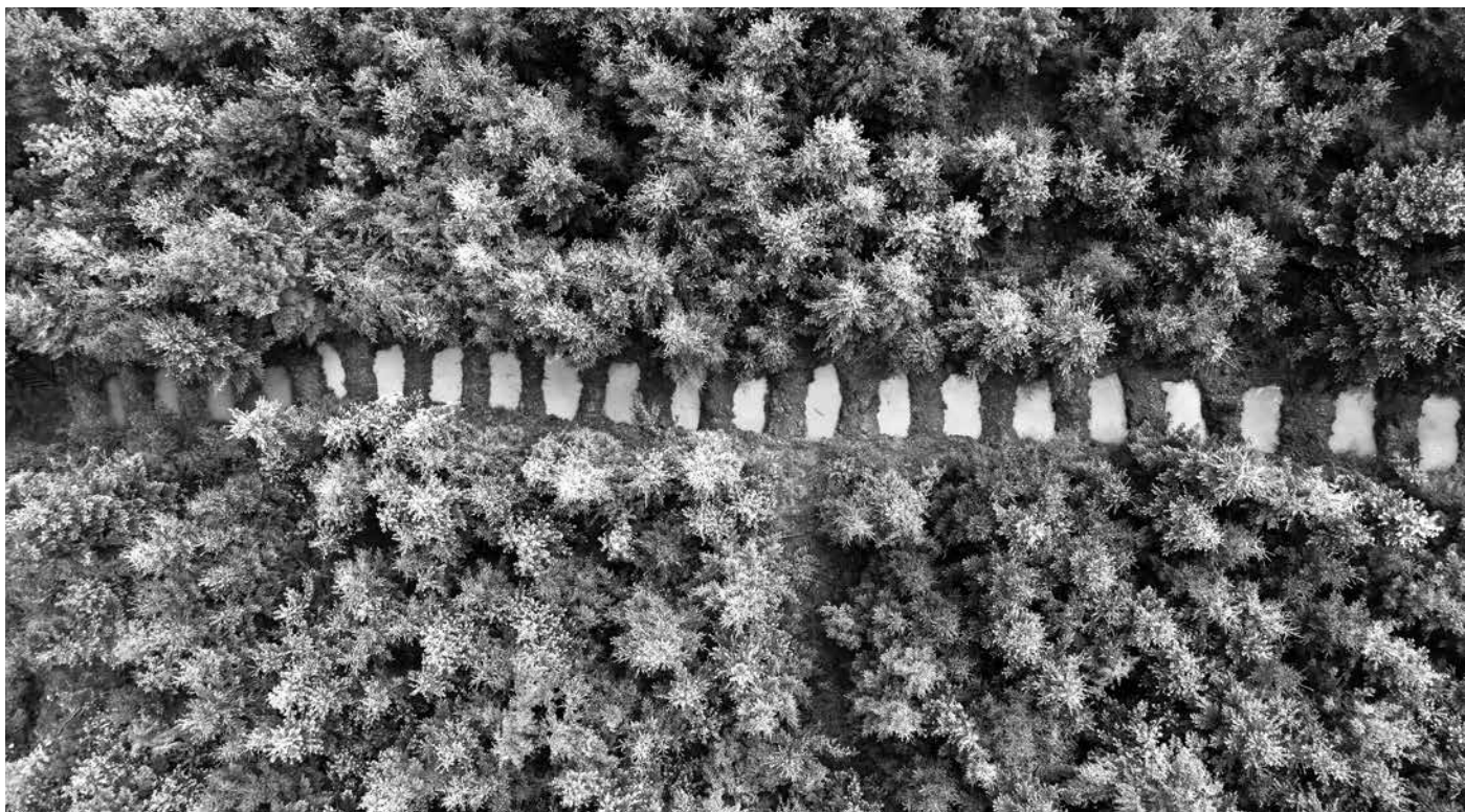
4) Pohled z dronu na přibližovací linku, která byla upravena pro potřeby zadržení vody v krajině pomocí systému na sebe navazujících tůní. Tímto opatřením došlo k akumulaci 150 000 l vody (zdroj Voda pro les, voda pro lidi).
